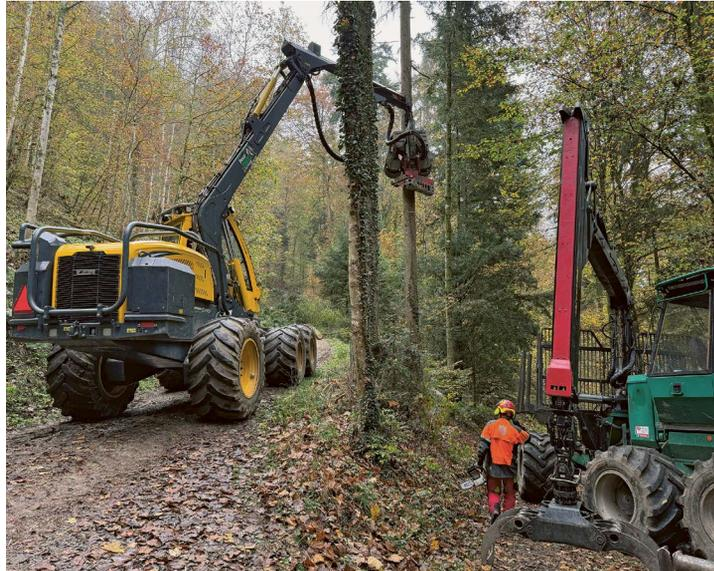
**Kolosse an der Arbeit: Der Holz-Vollernter (links) sägt den Baum ab, entastet und schneidet den Stamm auf die richtige Länge. Der Vorwarder übernimmt die Stämme und bringt diese zum vorgesehenen Standort, er kann bis 12 Tonnen zuladen.** Fotos: ks
