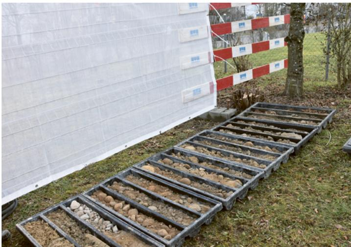
Aus dem Bohrkern gewonnene Bodenprofile geben dem Bohrmeister Aufschluss über jeden Meter der Bodenbeschaffenheit.
