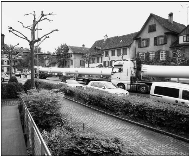
Zwei Schwertransporter schieben die Kaminanlage durch die Kreuzung.
