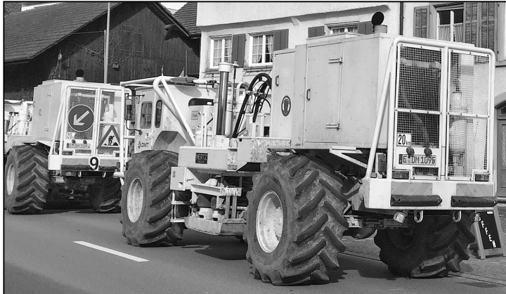
Solche Vibrationsfahrzeuge werden in unserer Region für die seismischen Messungen eingesetzt.
